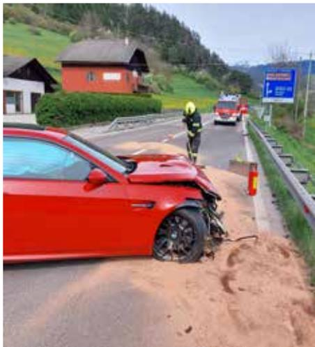
**Ölbindemittel auf der Fahrbahn aufgebracht und verteilt bindet ausgelaufenes Öl und Betriebsstoffe.**
