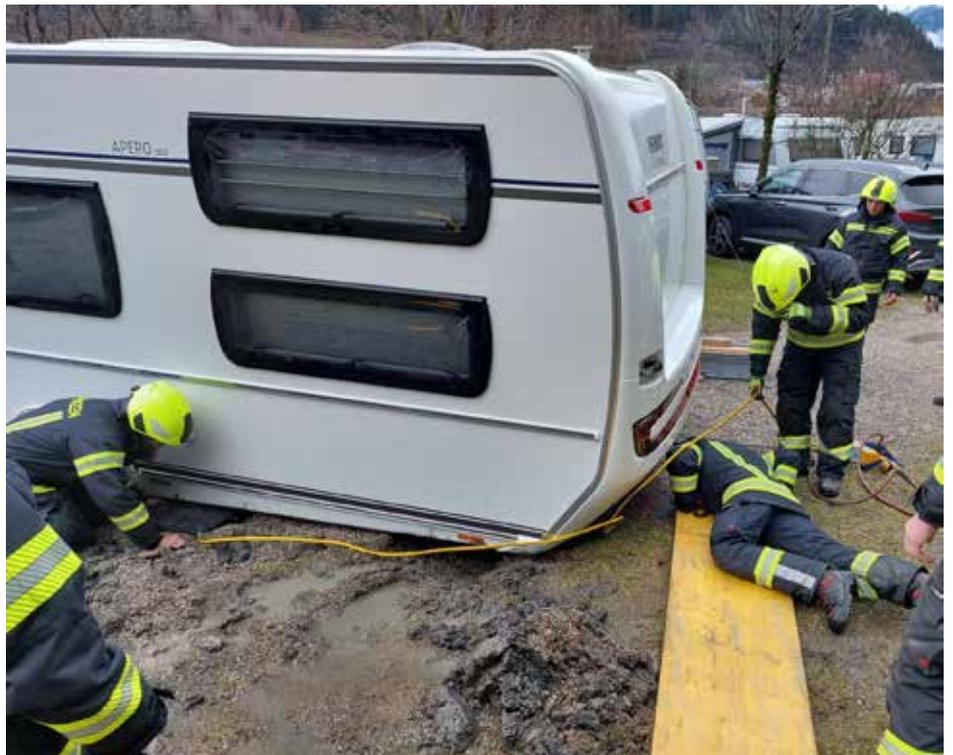
**Unter Zuhilfenahme von Drucklufthebekissen wird ein Wohnwagen schonend aus dem aufgeweichten Untergrund gehoben.**
