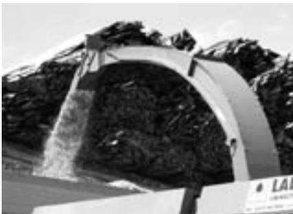
Mit dem Häcksler wird Holz auf die entsprechende Größe zerkleinert.
