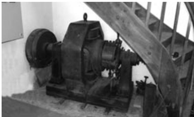
*Der schwere Generator wurde von den österreichischen Siemens-Werken geliefert. Er ist nicht mehr in Betrieb, sondern wurde mittlerweile durch einen neuen ersetzt.*
